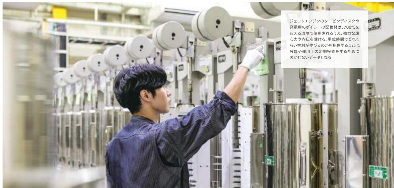
ジェットエンジンのタービンディスクや発電用のボイラーの配管材は、700℃を超える環境で使用されるうえ、強力な遠心力や内圧を受ける。単位時間でどれくらい材料が伸びるのかを把握することは、設計や運用上の定期検査をするために欠かせないデータとなる
