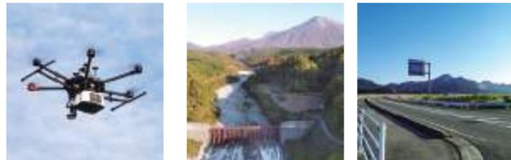
水中地形の計測が行えるUAV搭載型グリーンレーザー。水を含む広範囲な地形を短時間かつ安全に3次元化することができる。
